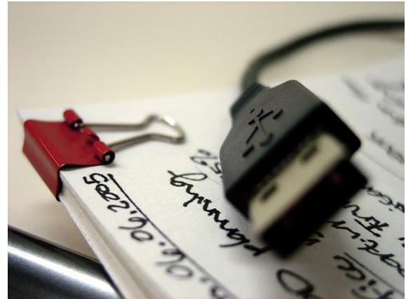
Il·lustració 29: Connector USB. Autoria: Teo. Obra amb llicència CC Reconeixement – Compartir igual 2.0
