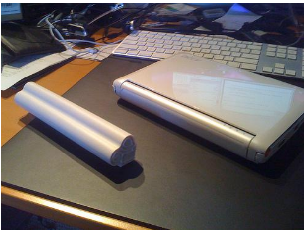
Il·lustració: 26: Bateria d'un notebook. Autoria: John Federico. Obra amb llicència CC Reconeixement – Compartir Igual 2.0
