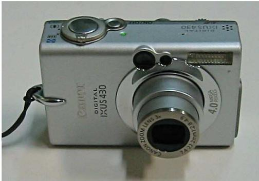
Las cámaras digitales utilizan un sensor electrónico **CCD** (*Charge-Coupled Device*<sup>6</sup>) que está dotado de pequeñas células fotoeléctricas que registran la imagen. Desde este sensor, la imagen es procesada por la cámara y enviada a la memoria.
